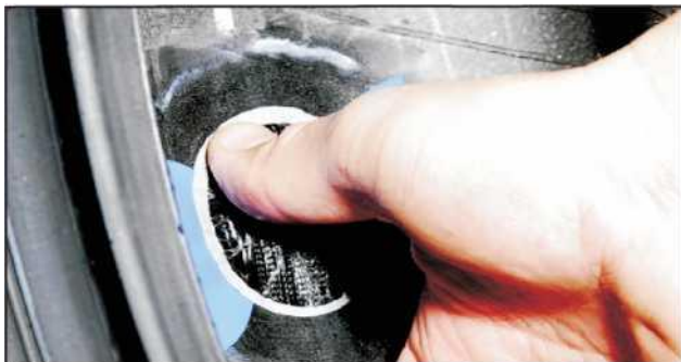
16 Zatlačte palcom do otvoru a zo stredu smerom von.
