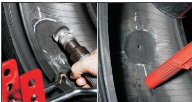
8. Použite mäkkú drôtenú kefu na odstránenie prachu a nečistôt z brúsenia a následne nečistoty odsajte vysávačom.
