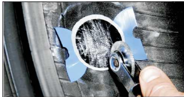
17 Modré póly ponechajte pod záplatou a stehujte tlakom záplatu smerom od stredu .
