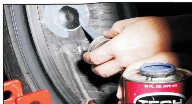
21. Okraj záplaty utesnite náterom ochrannej hmoty TECH Security Coat 738.
