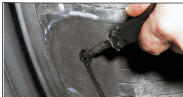
9. Na nanosenie cementu 760 použite špirálu. Nástrojom otáčajte v smere hodinových ručičiek . Opakujte 3-5 krát.
