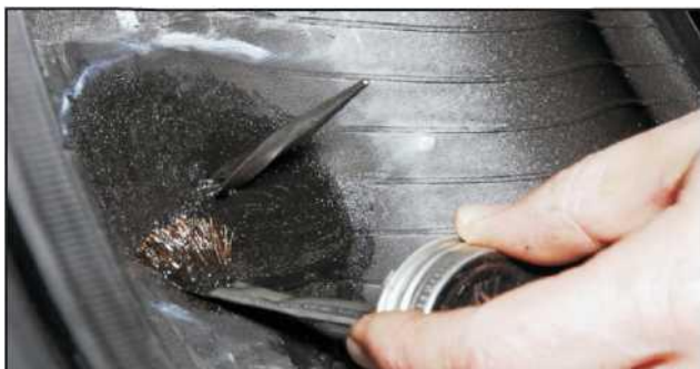
10. Naneste tenkú, rovnomernú vrstvu vulkanizačného roztoku 760 na obrúsený povrch.
