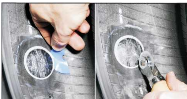
18. Vyberte poly z pod záplaty, stlačte dole po stranách a pokračujte v stehovaní smerom k okraju opravy.
